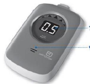
ファインサーチ中、クロス線をたどりながら最短距離を探します。このとき、Zoom+を回転させないで下さい。
