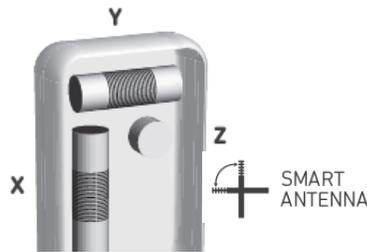
捜索中は3アンテナ全てが使用されます。XとYアンテナが距離と方向の指示に使用され、Zアンテナは単にファインサーチに使用されます。
