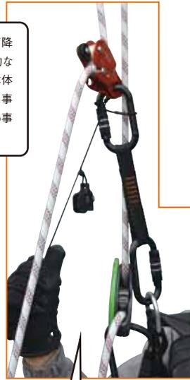
コードを強く引くとクリップ部分がローパー本体から外れ、確実に墜落を止めてくれる。
