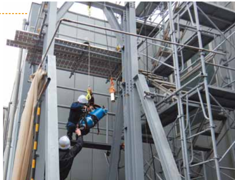
墜落制止用器具の規格適合検査の様様
