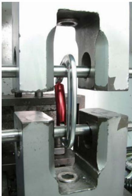
10KNの強度検査
