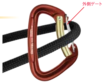
ツインゲートシステム 外側ゲートは内側に入らないのでロープはカラビナから外れない。
