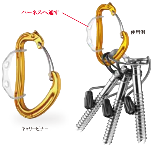
GV-ITCAB キャリアピナー.....定¥1,400+税 スクリューピトンの携帯ホルダー。ジュラルミン製。ピレーカラピナとしても応用出来る。 ●強度/25-9-10(KN) ●サイズ/120×70(mm) ●重量/68g
